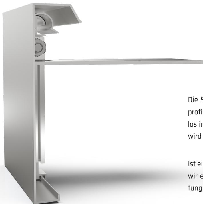
Die Serie FS ist ein mehrteiliges Dachrandabschlussprofil aus stranggepresstem Aluminium und ist stufenlos in der Höhe sowie Neigung verstellbar. Die Blende wird mit Hilfe der Halter bauseits befestigt.
