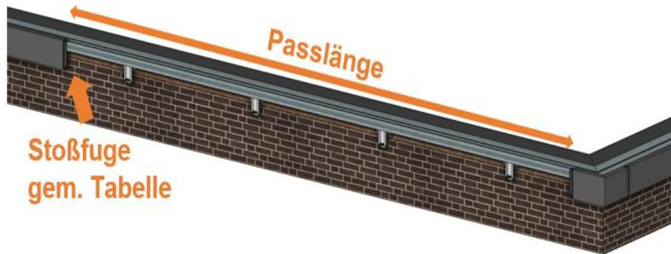
Die Schnittlinie der letzten Herstellerlänge wird mit Kreppband abgeklebt, bauseits auf die benötigte Länge zugeschnitten und entgratet.
